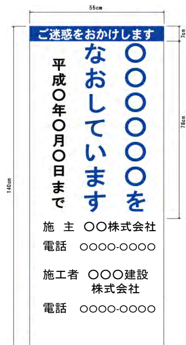
お知らせ看板B(施工中)
